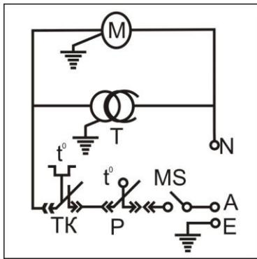
Приложение А. Схема соединений компрессора, мотора и вентилятора
