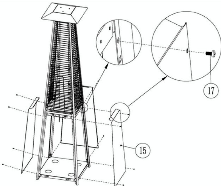
9. Закрепите 3 боковых панели(15) с помощью винтов(17).
