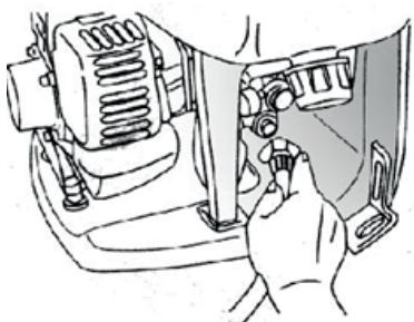
Не используйте распылитель, если он собран не полностью или имеет повреждения. Осмотрите распылитель, чтобы убедиться в его герметичности. Максимальная температура жидкости для распыления +43°C. Не используйте распылитель, если температура окружающей среды выше +45°C или ниже 0°C. Не используйте распылитель, если в баке нет жидкости.
