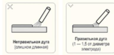
Очень важно, чтобы длина дуги была правильной, т.к. это влияет на сварочный ток и напряжение. Непрочный сварочный шов является результатом неправильного тока сварки. Наклон электрода (вперед) должен составлять  $70^\circ$  или  $80^\circ$ . При слишком большом наклоне сварочный шов может стать пористым.
