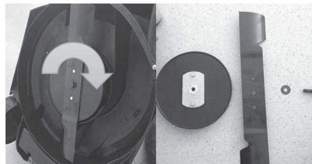
Положите Вашу газонокосилку набок так, чтобы обеспечить доступ к нижней стороне режущего блока. Воспользуйтесь тряпкой из плотной ткани или грубыми рукавицами, чтобы
