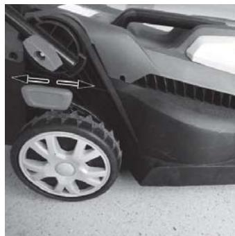
Газонокосилка имеет 5 положений регулировки.
