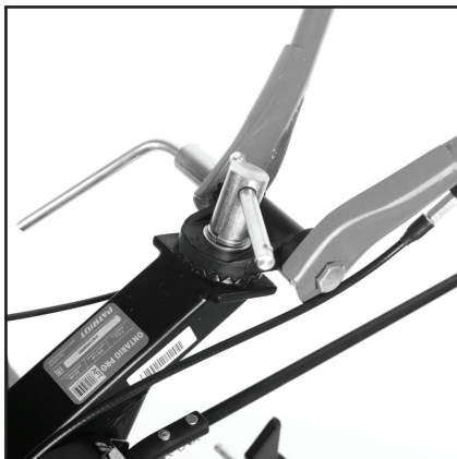
8.1 Установите руль (1) на место крепления, отрегулируйте высоту и затяните его крепежным винтом.
