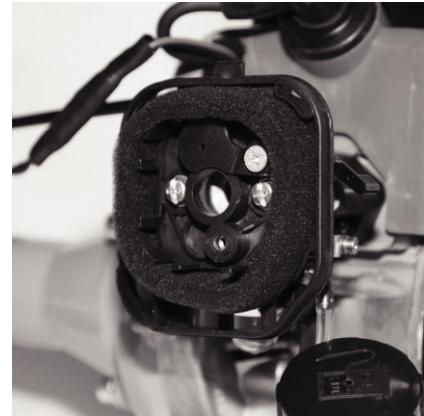
Вытащите воздушный фильтр и тщательно промойте его сначала в мыльном водном растворе, затем в чистой теплой воде. Высушите фильтр при комнатной температуре. Перед установкой фильтра пропитайте его 2-3 каплями моторного масла.
