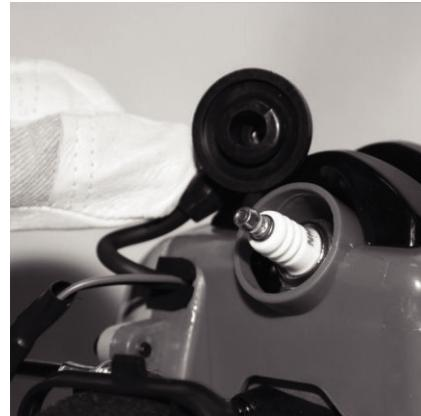
Регулярно проверяйте состояние свечи зажигания. Регулярно чистите свечу зажигания и проверяйте зазор между электродами. Зазор должен быть 0,5 мм.
