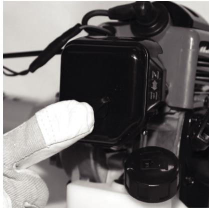
Снимите крышку воздушного фильтра.
